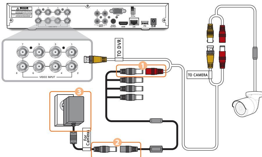
6. Conecte o adaptador de energia ao DVR através da porta CC 12V no painel traseiro e a ficha elétrica a uma tomada de parede. O DVR se irá ligar automaticamente e o assistente de inicialização irá aparecer no seu monitor.
