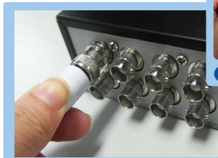
2 Eine BNC Kamera anschließen
